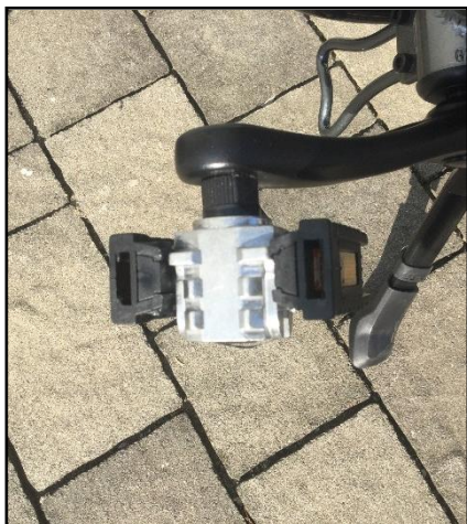
Figura 4– Pedale in posizione di trasporto (sx) e utilizzo (dx).
