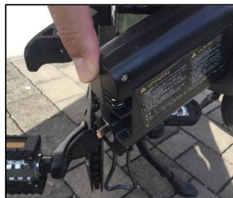
Figura 14 – Batteria parzialmente estratta.
