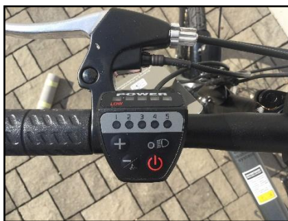
Figura 11 – Dispositivo di comando assistenza sul manubrio sinistro.
