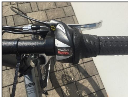
Figura 10 – Posizione del comando/indicatore del cambio.
